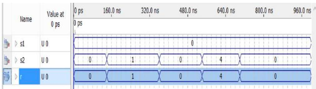
Figura 3.10. Respuesta de la simulación del sumador
